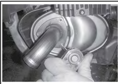
TYPIQUE - RETRAIT DU TUYAU ARRIÈRE
