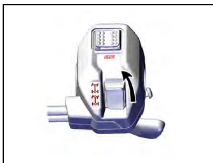
MODE 2 ROUES MOTRICES - TYPIQUE
