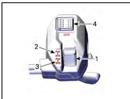
MODE 4 ROUES MOTRICES - TYPIQUE TYPIQUE
