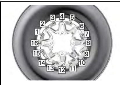
TYPIQUE - SÉQUENCE DE SERRAGE FINAL
