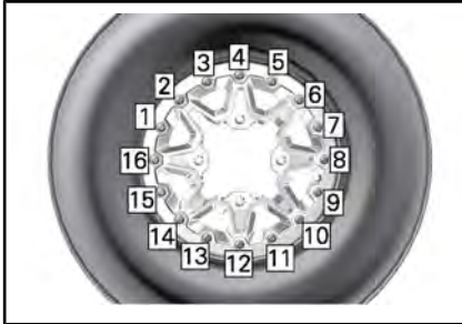
TYPIQUE - SÉQUENCE DE SERRAGE FINALE
