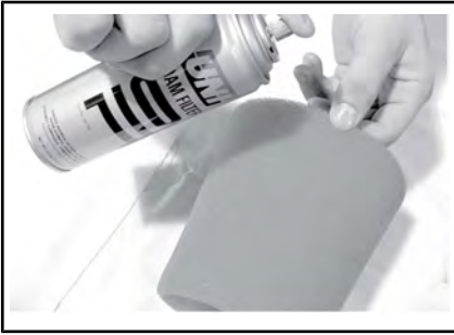
TÍPICO - LUBRIQUE EL FILTRO DE ESPUMA.
