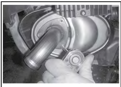
ТИПОВОЙ ВАРИАНТ - СНЯТИЕ ВЫХЛОПНОЙ ТРУБЫ
