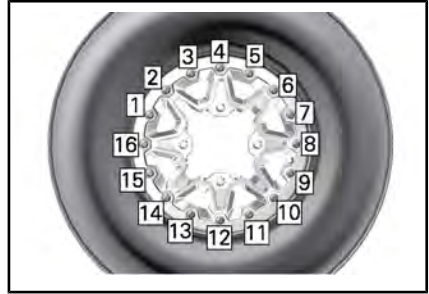
ТИПОВОЙ ВАРИАНТ - ЗАКЛЮЧИТЕЛЬНЫЙ ЭТАП ЗАТЯЖКИ ВИНТОВ
