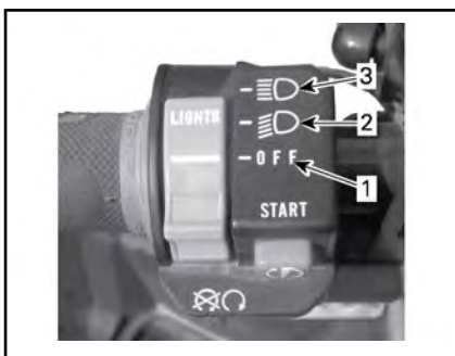
ФУНКЦИИ ПЕРЕКЛЮЧАТЕЛЯ СВЕТА ФАР
