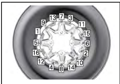
ТИПОВОЙ ВАРИАНТ - ПОРЯДОК ЗАТЯЖКИ ВИНТОВ
