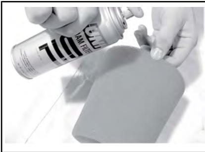
ТИПОВОЙ ВАРИАНТ - НАНЕСЕНИЕ МАСЛА НА ПОРОЛОНОВЫЙ ФИЛЬТР
