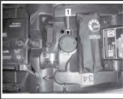
1. Компенсационный бачок заднего тормоза
