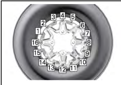
SITUAZIONE TIPICA - SEQUENZA DI SERRAGGIO FINALE
