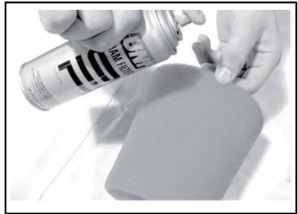
ТИПОВОЙ ВАРИАНТ – НАНЕСЕНИЕ МАСЛА НА ПОРОЛОНОВЫЙ ФИЛЬТР
