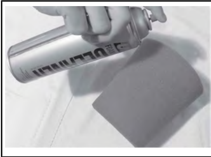
ТИПОВОЙ ВАРИАНТ – НАНЕСЕНИЕ МАСЛА НА ПОРОЛОНОВЫЙ ФИЛЬТР
