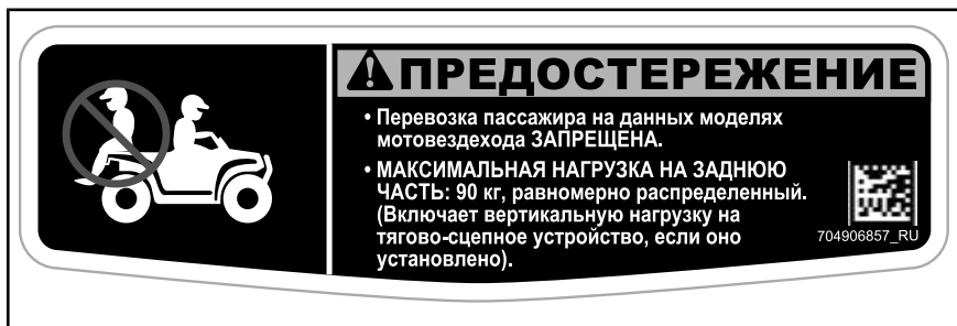
НАКЛЕЙКА 6 — Outlander X mr (650/850/1000R): ЗАДНЕЕ КРЫЛО (ДЛЯ ОЗНАКОМЛЕНИЯ СО ЗНАЧЕНИЯМИ СМ. РАЗДЕЛ ТЕХНИЧЕСКИХ ХАРАКТЕРИСТИК)
