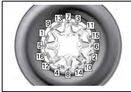
VANLIG – ÅTDRAGNINGSSKVENSS
