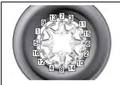
VANLIG – ÅTDRAGNINGSSKVENSS
