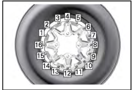
TYPISCH - LAATSTE AANDRAAIVOLGORDE
