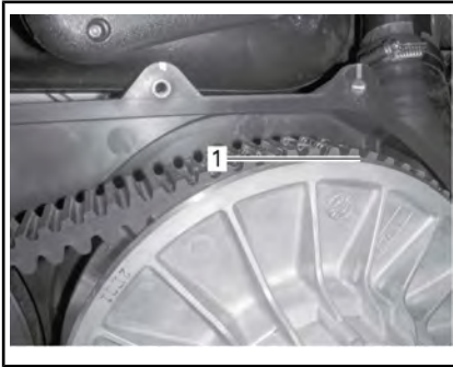
1. Den nederste delen av tennene i kant med den eksterne overflaten til drivreimen
