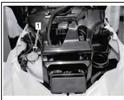
1. Réservoir du liquide de refroidissement
