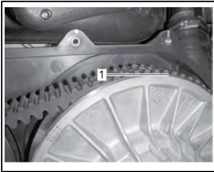
1. Variaattorihihnan ulkopinnan hammersuksen alin osa
