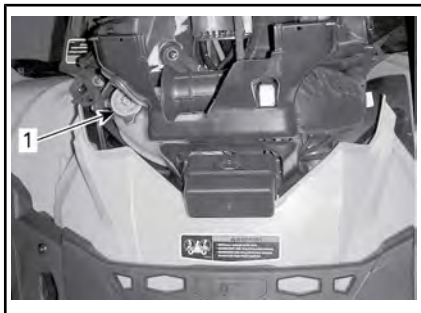
1. Réservoir du liquide de refroidissement
