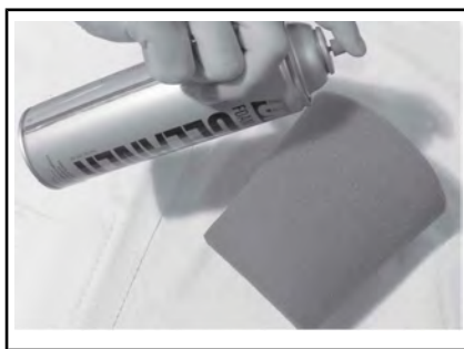
TYPIQUE - VAPORISEZ LE FILTRE EN MOUSSE
