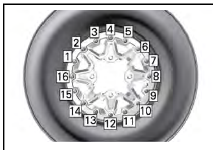
TYPIQUE - SÉQUENCE DE SERRAGE FINAL
