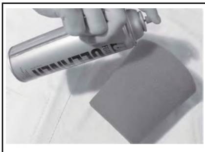
ТИПОВОЙ ВАРИАНТ – НАНЕСЕНИЕ МАСЛА НА ПОРОЛОНОВЫЙ ФИЛЬТР
