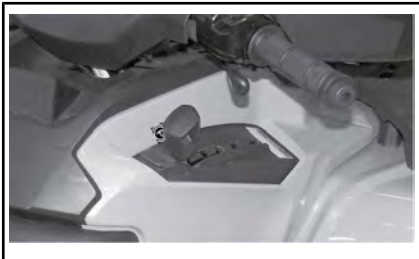
РАСПОЛОЖЕНИЕ РЫЧАГА ПЕРЕКЛЮЧЕНИЯ ПЕРЕДАЧ
