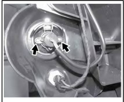
ВЫВЕРНИТЕ ВИНТЫ КРЕПЛЕНИЯ ЛАМПЫ ПЕРЕДНЕГО УКАЗАТЕЛЯ ПОВОРОТА
