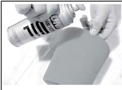
ТИПОВОЙ ВАРИАНТ - НАНЕСЕНИЕ МАСЛА НА ПОРОЛОНОВЫЙ ФИЛЬТР
