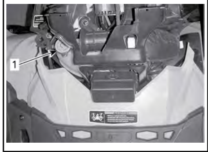
1. Крышка расширительного бачка системы охлаждения двигателя
