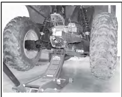
ТИПОВОЙ ВАРИАНТ — ЗАДНЯЯ ТОЧКА ПОДЪЕМА
