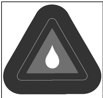
НА БАЧКАХ ТОРМОЗНОЙ ЖИДКОСТИ
