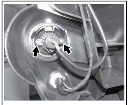
DESATORNILLE LOS TORNILLOS DE FIJACIÓN DE LA BOMBILLA DEL INTERMITENTE DELANTERO
