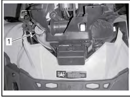
1. Depósito de refrigerante del motor
