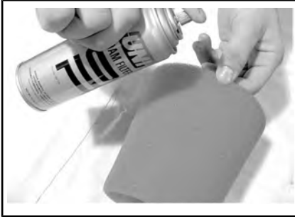
ТИПОВОЙ ВАРИАНТ - НАНЕСЕНИЕ МАСЛА НА ПОРОЛОНОВЫЙ ФИЛЬТР
