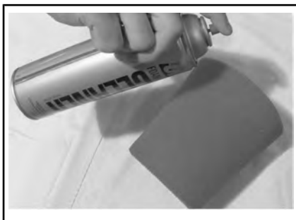
ТИПОВОЙ ВАРИАНТ – НАНЕСЕНИЕ МАСЛА НА ПОРОЛОНОВЫЙ ФИЛЬТР
