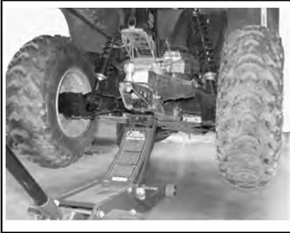
CONFIGURAZIONE TIPICA - PUNTO DI SOLLEVAMENTO POSTERIORE
