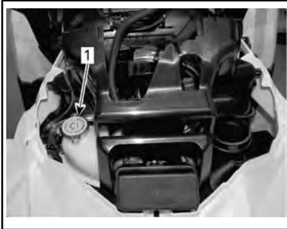
1. Tappo del serbatoio liquido refrigerante motore
