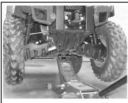
CONFIGURAZIONE TIPICA - PUNTO DI SOLLEVAMENTO ANTERIORE
