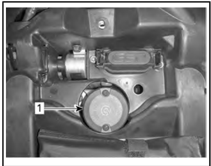
1. Компенсационный бачок заднего тормоза
