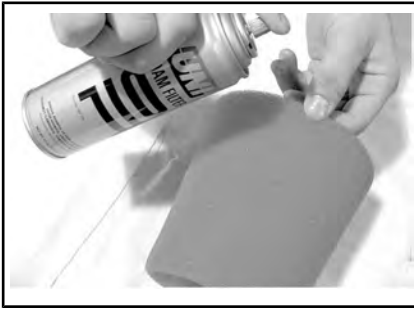
ТИПОВОЙ ВАРИАНТ - НАНЕСЕНИЕ МАСЛА НА ПОРОЛОНОВЫЙ ФИЛЬТР
