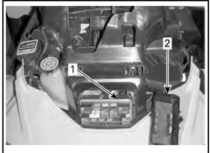
1. Передний блок предохранителей 2. Крышка переднего блока предохранителей
