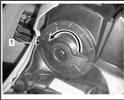
1. Крышка воздушного фильтра
