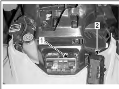
1. Vorderer Sicherungskasten 2. Abdeckung des vorderen Sicherungskastens
