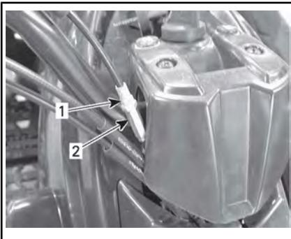
1. Фиксирующая гайка
