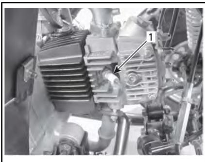
1. Свеча зажигания
