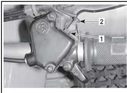
1. Фиксирующая гайка
