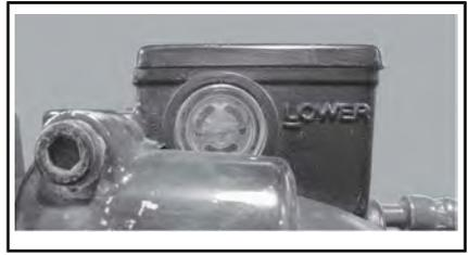
*ЛЕВЫЙ ЗАДНИЙ БАЧОК ДЛЯ ТОРМОЗНОЙ ЖИДКОСТИ*
