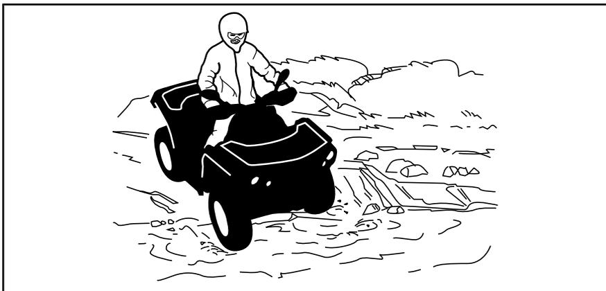
Попадание воды на тормозные механизмы оказывает неблагоприятное влияние на эффективность тормозной системы. После преодоления водной преграды, движения по грязи или снегу просушите тормозные колодки, несколько раз приведя тормоза в действие.
