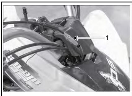
**РЕГУЛИРОВКА ТРОСА ОТ РЫЧАГА ДРОССЕЛЬНОЙ ЗАСЛОНКИ К РЕГУЛЯТОРУ ОГРАНИЧЕНИЯ ОТКРЫТИЯ ДРОССЕЛЬНОЙ ЗАСЛОНКИ**
