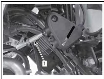
**РЕГУЛИРОВКА ТРОСА ОТ РЕГУЛЯТОРА ОГРАНИЧЕНИЯ ОТКРЫТИЯ ДРОССЕЛЬНОЙ ЗАСЛОНКИ К ДВИГАТЕЛЮ**
