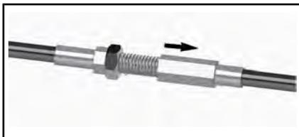
**ОТВЕРНИТЕ РЕГУЛИРОВОЧНУЮ ГАЙКУ**
