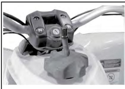
ТИПОВОЙ ВАРИАНТ — КРЫШКА ТОПЛИВНОГО БАКА
