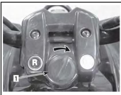
**ТИПОВОЙ ВАРИАНТ** — ПОВЕРНИТЕ В ПОЛОЖЕНИЕ «ON»
