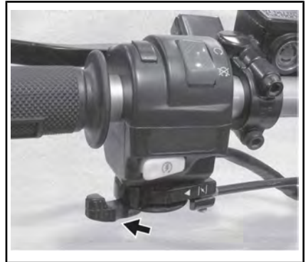
CHOKE BIS ZUM ANSCHLAG BETÄTIGT
