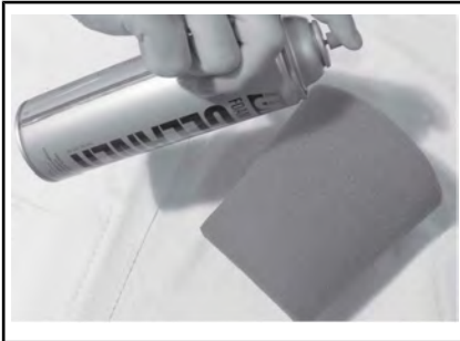
ТИПОВОЙ ВАРИАНТ — НАНЕСЕНИЕ НА ВНУТРЕНнюю И НАРУЖНУЮ ПОВЕРХНОСТИ ПОРОЛОНОВОГО ФИЛЬТРУЮЩЕГО ЭЛЕМЕНТА СПЕЦИАЛЬНОГО ЧИСТЯЩЕГО СРЕДСТВА
