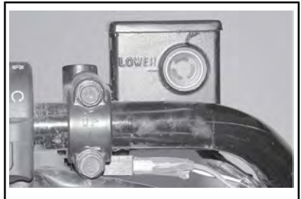
ТИПОВОЙ ВАРИАНТ — БАЧОК ТОРМОЗНОЙ ЖИДКОСТИ ЗАДНЕГО ТОРМОЗА, НА РУЛЕ СЛЕВА
