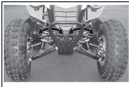
LOCAIS PARA CORREIAS NO PARA-CHOQUE DIANTEIRO
