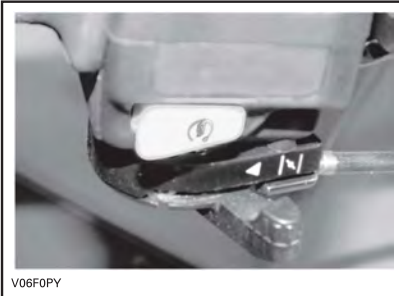
ALAVANCA DO AFOGADOR NA POSIÇÃO DESL.
