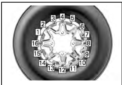
TYPISCH - LAATSTE AANDRAAIVOLGORDE
