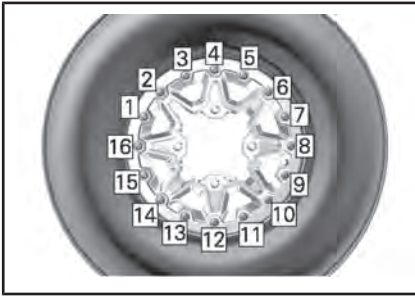
TYYPILLINEN – LOPULLINEN KIRISTYS-JÄRJESTYS
