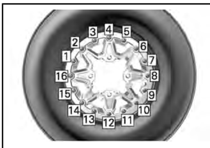
TYPBILD - SLUTLIG ÅTDRAGNINGSSEKVENS
