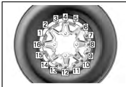
TYPISCH - LAATSTE AANDRAAIVOLGORDE
