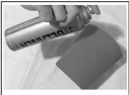
TYPISCH - SPUIT HET OP DE SCHUIMFILTER
