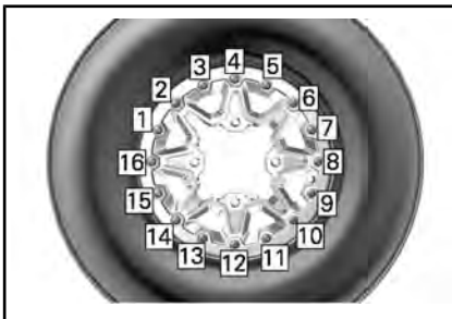
SITUAZIONE TIPICA - SEQUENZA DI SERRAGGIO FINALE
