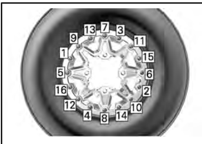
SITUAZIONE TIPICA - SEQUENZA DI SERRAGGIO
