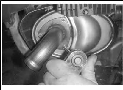
CONFIGURAZIONE TIPICA - RIMUOVERE IL TUBO DI CODA
