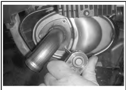
TYPIQUE - RETRAIT DU TUYAU ARRIÈRE
