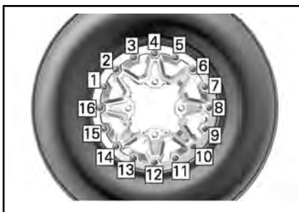
TYPIQUE - SÉQUENCE DE SERRAGE FINALE
