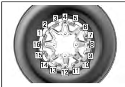
TYPIQUE - SÉQUENCE DE SERRAGE FINALE
