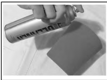
TYPIQUE - VAPORISEZ LE FILTRE EN MOUSSE
