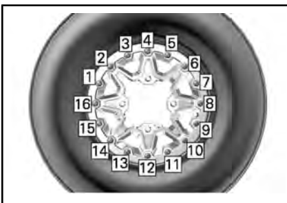
TYYPILLINEN – LOPULLINEN KIRISTYSJÄRJESTYS
