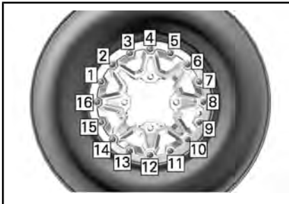
ТИПОВОЙ ВАРИАНТ - ЗАКЛЮЧИТЕЛЬНЫЙ ЭТАП ЗАТЯЖКИ ВИНТОВ
