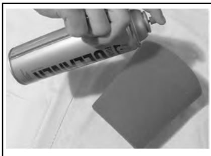
ТИПОВОЙ ВАРИАНТ – НАНЕСЕНИЕ МАСЛА НА ПОРОЛОНОВЫЙ ФИЛЬТР
