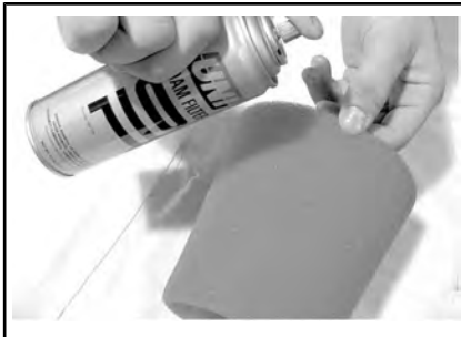
ТИПОВОЙ ВАРИАНТ - НАНЕСЕНИЕ МАСЛА НА ПОРОЛОНОВЫЙ ФИЛЬТР
