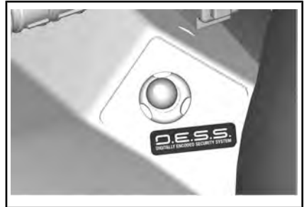
D.E.S.S. КОНТАКТНОЕ УСТРОЙСТВО
