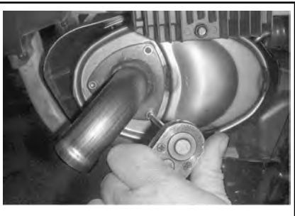
ТИПОВОЙ ВАРИАНТ - СНЯТИЕ ВЫХЛОПНОЙ ТРУБЫ
