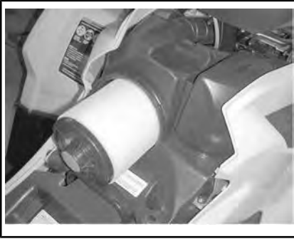
REMOÇÃO DO FILTRO DE AR
