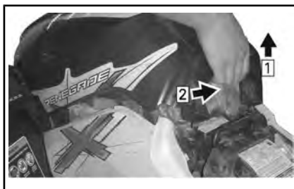
Stap 1: Optrekken Stap 2: Naar achteren trekken
