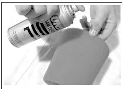
TYPISCH - FILTER MET OLIE SMEREN
