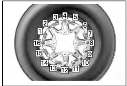
TYPISCH - LAATSTE AANDRAAIVOLGORDE
