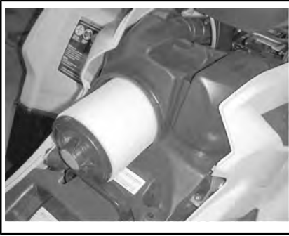
VERWIJDEREN VAN DE LUCHTFILTER
