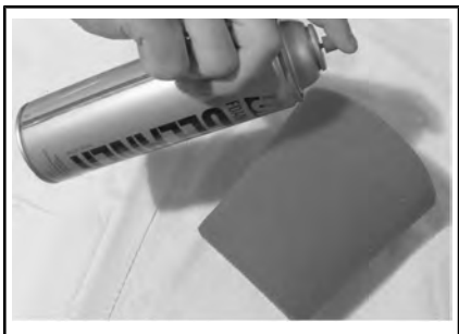
TYPISCH - SPUIT HET OP DE SCHUIMFILTER
