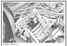
RH SIDE — REAR CYLINDER 1. Spark plug
