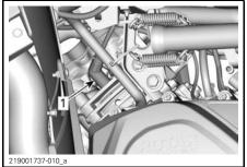
LH SIDE — FRONT CYLINDER 1. Spark plug
