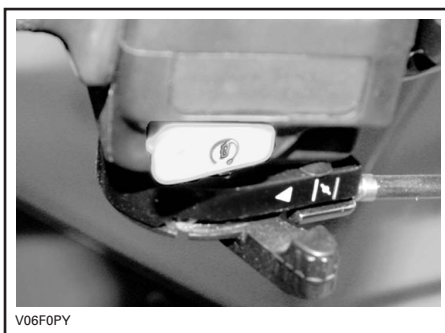
PALANCA DEL ESTRANGULADOR DE AIRE EN POSICIÓN DE ESTRANGULADOR CERRADO
