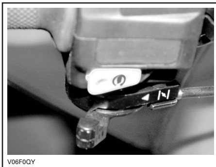
PALANCA DEL ESTRANGULADOR DE AIRE EN POSICIÓN DE ESTRANGULADOR ABIERTO
