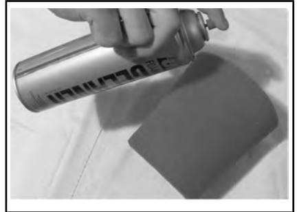
SITUAZIONE TIPICA - SPRUZZARE IL FILTRO IN MATERIALE ESPANSO
