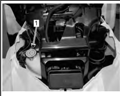
1. Serbatoio liquido refrigerante motore
