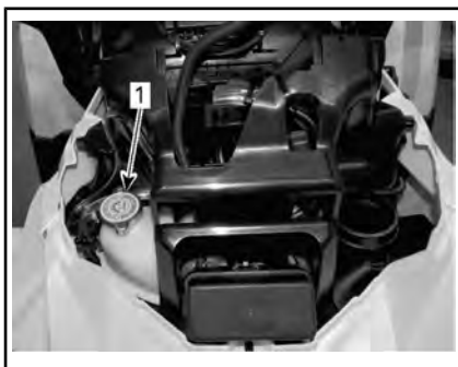
1. Réservoir du liquide de refroidissement
