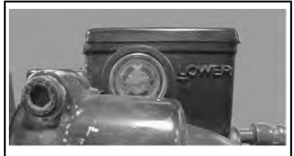
SERBATOIO LIQUIDO DEI FRENI POSTERIORI SUL LATO SINISTRO
