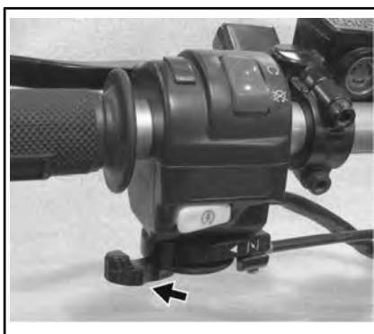
DISPOSITIVO ARIA IN POSIZIONE FULL
