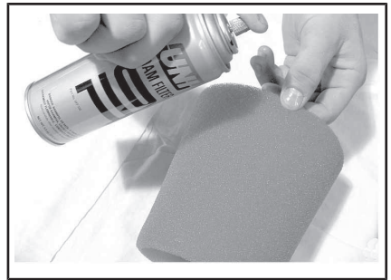
TÍPICO - ENGRASE CON ACEITE EL ELEMENTO DEL FILTRO DE ESPUMA
