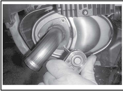
TYPBILD - TA BORT SLUTRÖRET
