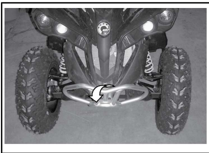
TYPBILD - PLACERING AV FRÄMRE FÄSTPUNKT
