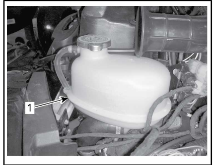
1. Behållare för motorkylvätska
