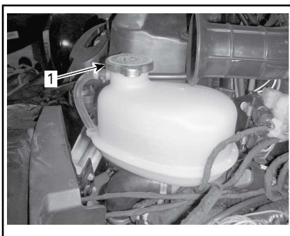
1. Lock till motorns kylvätskebehållare
