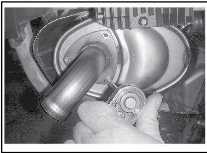
TYPEBILDE – FJERNING AV UTBLÅSINGSRØR
