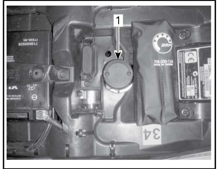
1. Behälter für Bremsflüssigkeit der hinteren Bremse
