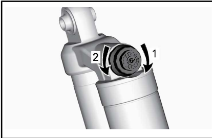
DRUCKSTUFENDÄMPFUNG - OBEN AM STOßDÄMPFER
