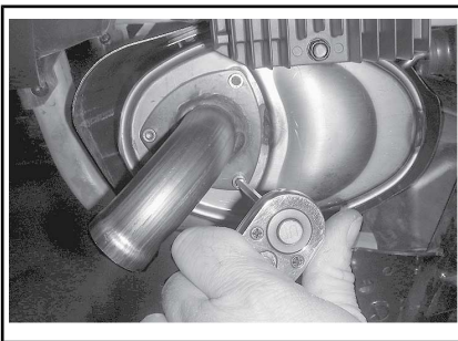
TYPISCH - ABGASROHR ENTFERNEN
