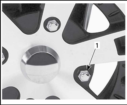
TYPISCH — ALUMINIUMRAD 1. Radmutter (mit geschlossener Endung)
