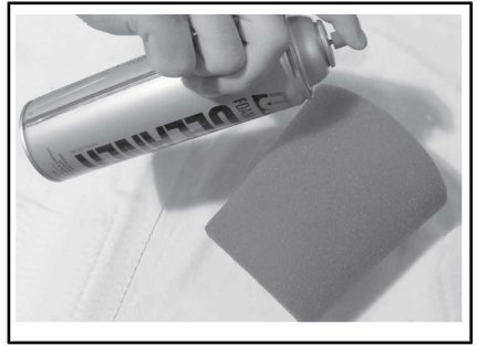
TYPISCH - SCHAUMSTOFFFILTER BE- SPRÜHEN
