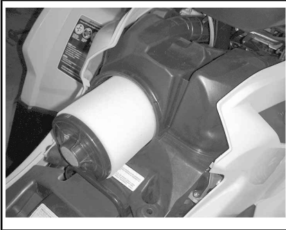
AUSBAU DES LUFTFILTERS
