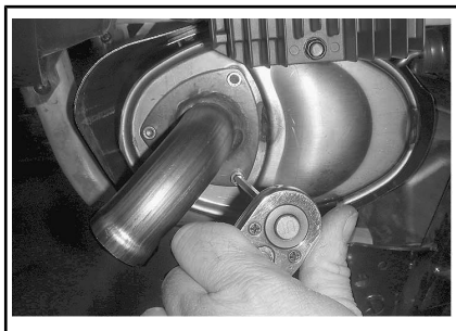
TYPISCH - ABGASROHR ENTFERNEN
