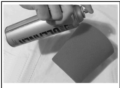
TYPISCH - SCHAUMSTOFFFILTER BE- SPRÜHEN
