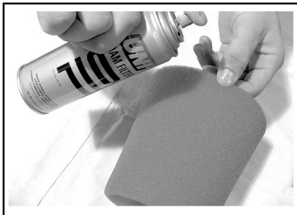
TYPISCH - SCHAUMSTOFFFILTER ÖLEN
