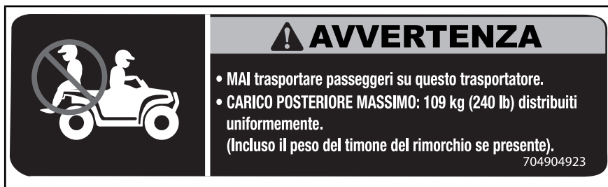
ETICHETTA 6 - OUTLANDER X mr (570): PARAURTI POSTERIORE (VEDERE LE CARATTERISTICHE TECNICHE PER I VALORI)
