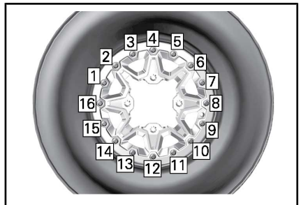
TYPEBILDE – TILTREKKINGSREKKEFØLGE SISTE TILTREKKING
