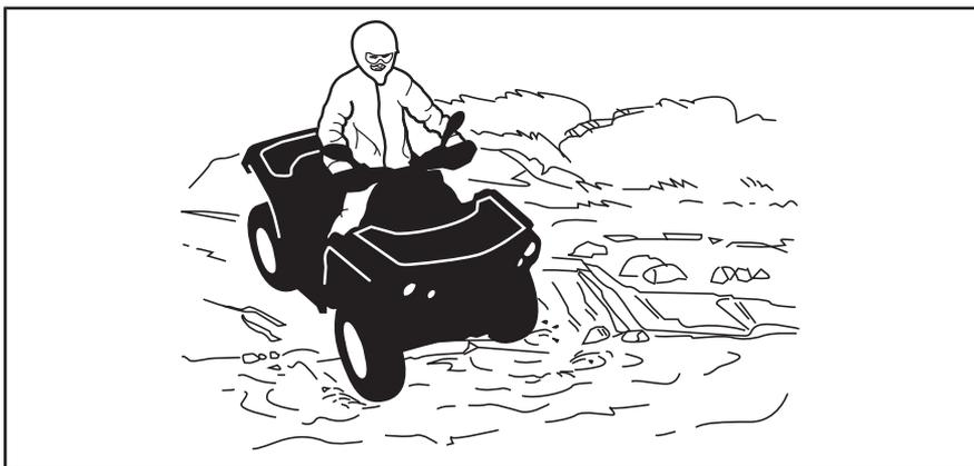
水による制動は、車両の制動能力に影響します。車両が水たまり、泥または雪から離れた後は、ブレーキを数回かけて乾燥させてください。制動距離を長めに取ってください。
