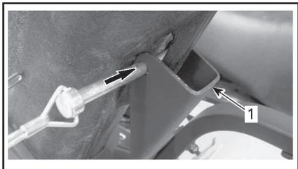
1. ガンブーツサポートの曲げプレートロックをピンに取り付けます。
