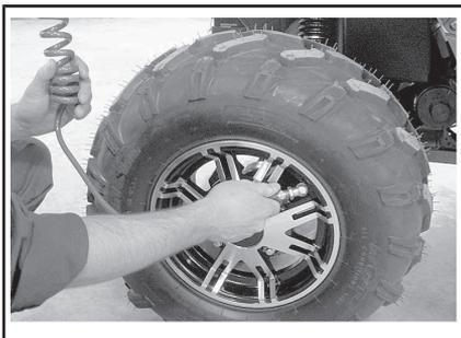
注：空気圧を測定できるように、工具キットには圧力ゲージが付属しています。
