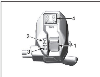
MODE 4 ROUES MOTRICES - TYPIQUE TYPIQUE
