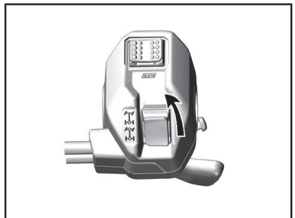
MODE 2 ROUES MOTRICES - TYPIQUE
