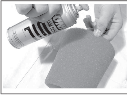
TÍPICO - LUBRIQUE EL FILTRO DE ESPUMA.
