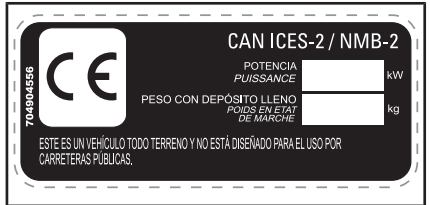
UBICACIÓN: BAJO EL ASIENTO, SOBRE LA SECCIÓN SUPERIOR DEL BASTIDOR
