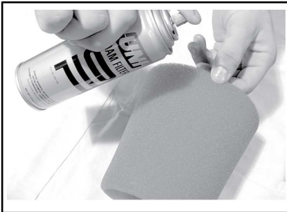
SITUAZIONE TIPICA - LUBRIFICARE IL FILTRO IN MATERIALE ESPANSO
