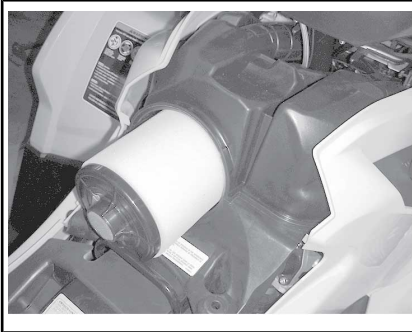
EXTRACCIÓN DEL FILTRO DE AIRE
