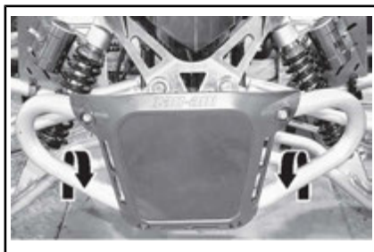
DS 90 X – POSIZIONE DEL PUNTO DI ANCORAGGIO ANTERIORE
