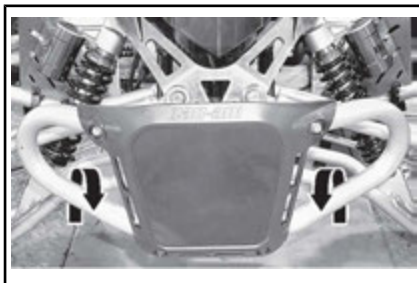
DS 90 X, UBICACIÓN DEL PUNTO DE ANCLAJE DELANTERO
